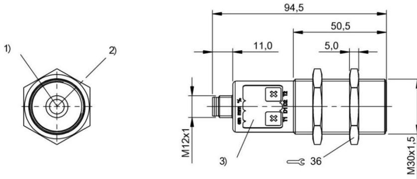
1) 轴, 超声波转换器 2) 退出方向, 90°插头 3) 显示和操作区
