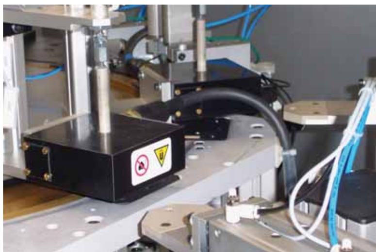
▲ 图示为MAGNATEST线圈检测气门座硬度，通过塑料心轴确保气门座在线圈中精确进料及定位，提高检测速度。
