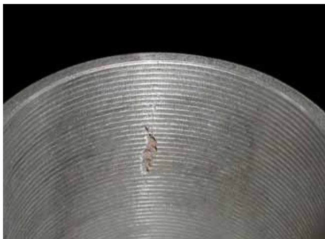
▲ 自动检测到的表面缺陷实例。
