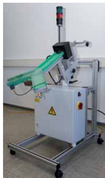
▲ 用于工件微观组织结构检测的手动检测系统，含有自动启动功能 (内部触发) 和检测结果双向分选装置。
