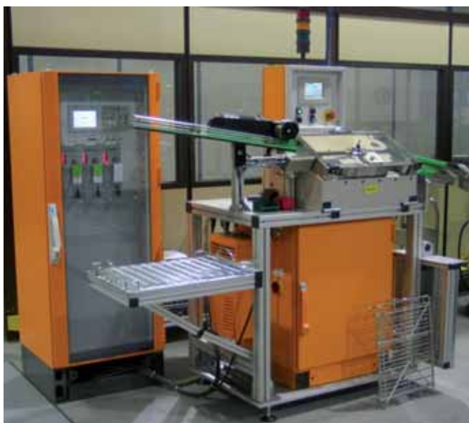
▲ 三通道全自动涡流裂纹探伤检测系统 (ROTO-SCAN)，工件手动上料，或者集成在生产线上。
