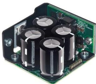
**PLDD-200-12-20-2x2 型**是我们标准 200 A 脉冲电流源的超紧凑轻量版本，用于驱动激光二极管巴条、激光二极管巴条阵列或任何低阻抗负载。该器件具有 200A 的高峰值电流，上升时间 $<10\mu\text{s}$ （取决于负载），最大脉冲宽度为  $300\mu\text{s}$ 。脉冲重复频率可以从单脉冲到 20Hz。
