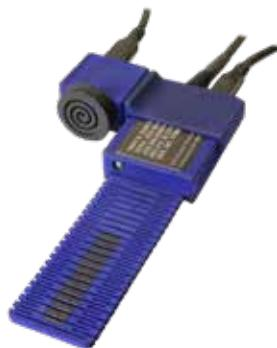
检查管道、压力容器或油罐上的腐蚀或裂纹。Surf-X 灵活阵列检测探头可以灵活适应管道、压力容器或油罐几何形状的变化，因而可以检测铝和不锈钢等各种材料表面和近表面的缺陷。对于非压力部件而言腐蚀是常见缺陷，而对于需要在腐蚀环境中承受持续拉伸应力的部件，常见缺陷则是应力腐蚀裂纹。使用高精度嵌入式编码器跟踪位置，Surf-X 阵列检测探头可以轻松确定这两种缺陷的位置。
