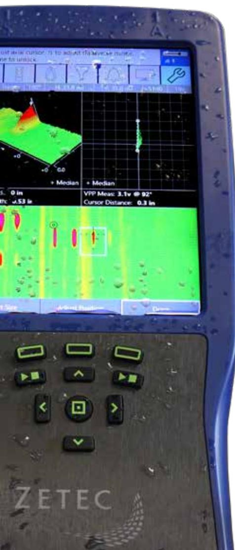
**多层腐蚀检测。**鉴别腐蚀程度是机身结构检测中最关键也是最复杂的检测之一。蒙皮厚度和多层结构的差异通常会使得信号难以识别。MIZ-21C 拥有穿透较厚区域的能力。卓越的信噪比有助于检测者区分哪怕是很轻微的材料损伤。双频混频功能几乎可以消除会“掩盖”有用信号的干扰信号，这种干扰信号是由于多层构件中空隙的差异而产生的。
